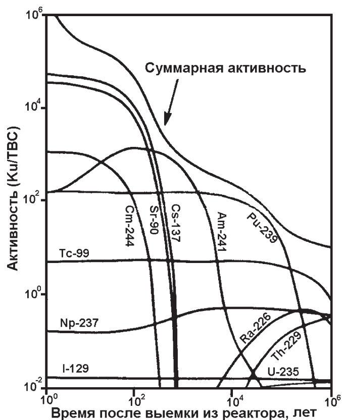
Рис. 1. Изменение радиоактивности тепловыделяющей сборки (ТВС) ОЯТ реактора PWR во времени [Brookins, 1984]
